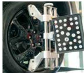
Rápidas y fáciles de usar con un diseño autocentrante, las garras de dos lados proporcionan una sujeción fiable, incluso sobre los tapacubos.
