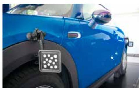
Diga adiós a la introducción manual de datos, acelere las mediciones y aumente la precisión utilizando nuestros objetivos de altura de conducción opcionales y especialmente diseñados.
